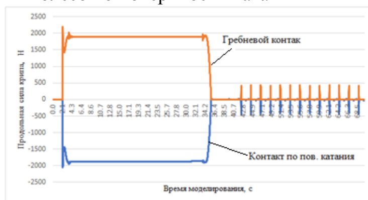
Рис. 8 – Продольная сила крива, действующая на наружное колесо
