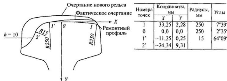
Рис. 5 – Ремонтный профиль рельса Р65 с боковым износом h=10 мм (наружная рельсовая нитка)
