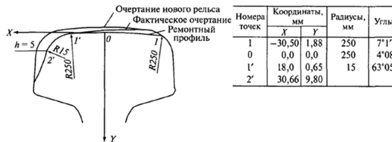
Рис. 4 – Ремонтный профиль рельса Р65 с боковым износом h=5 мм (наружная рельсовая нитка)
