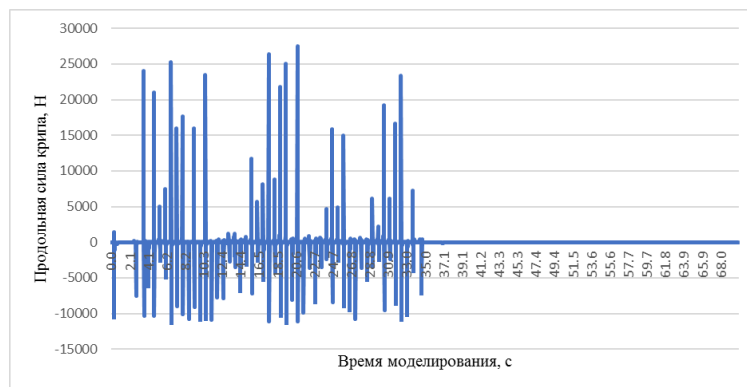
Рис. 6 – Продольная сила крива, действующая на наружное колесо по поверхности катания
