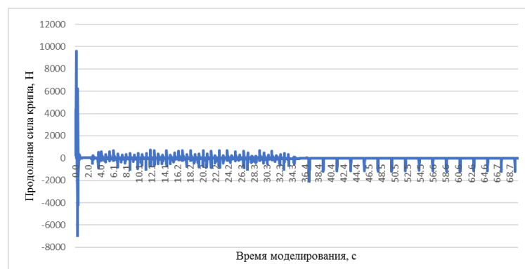
Рис. 7 – Продольная сила крива, действующая на внутреннее колесо по поверхности катания
