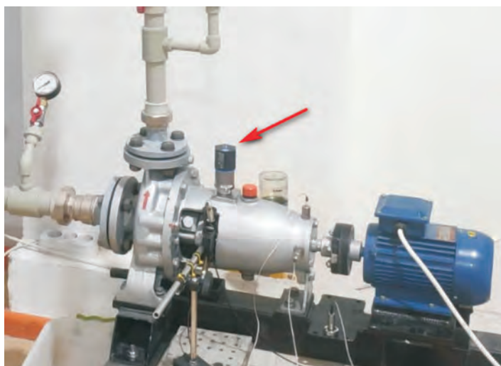
Рисунок 3 – Экспериментальный стенд с установленным датчиком WISE-2410
