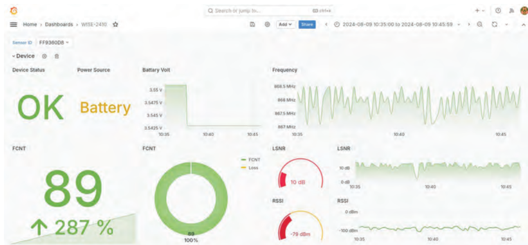
Рисунок 4 – Панель мониторинга для контроля состояния датчиков и канала связи
