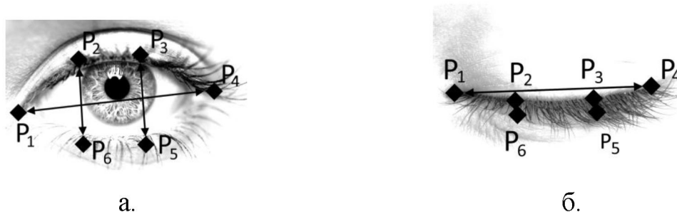
Рисунок 2 – Реперные точки для расчета метрики EAR : а. глаз открыт; б. глаз закрыт
