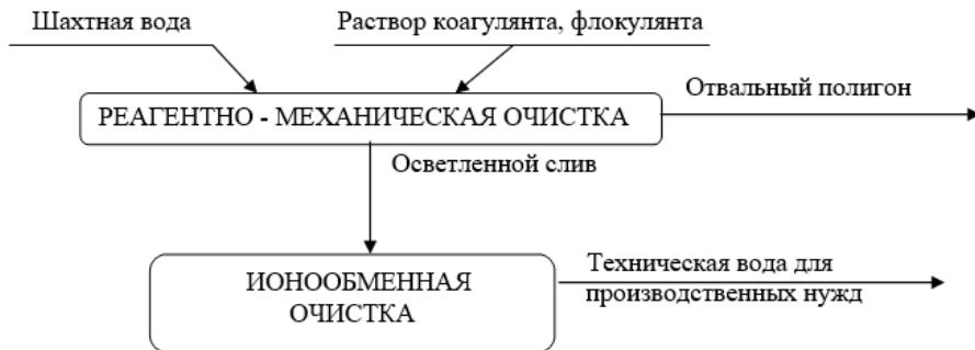
**Рисунок 7 – Принципиальная технологическая схема получения технической воды с использованием методов ионного обмена.**
