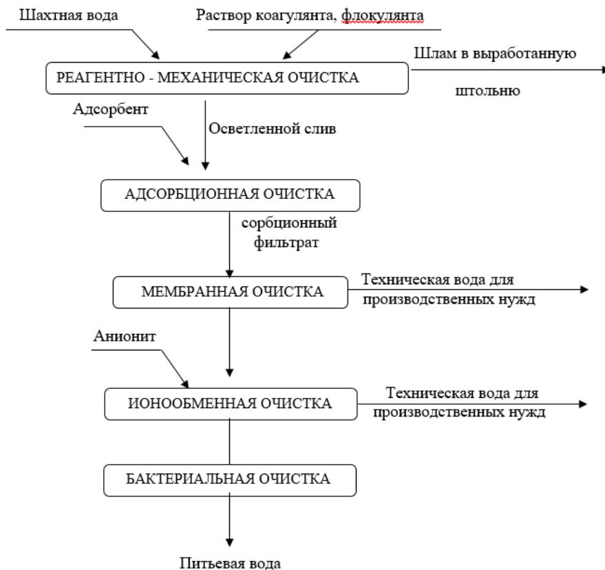
**Рисунок 4–** Принципиальная технологическая схема деминерализации и обезвреживания.
