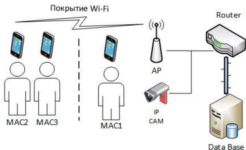
Рисунок 2. Структурная схема системы двухфакторной идентификации
