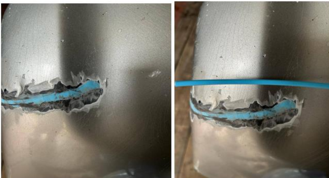
Рисунок 5 – Сварной шов и проволока для сварки
