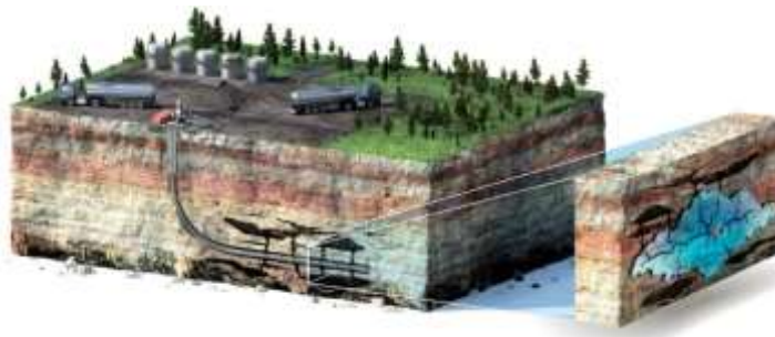
Рисунок 1 - Схематическое изображение гидроразрыва пласта
