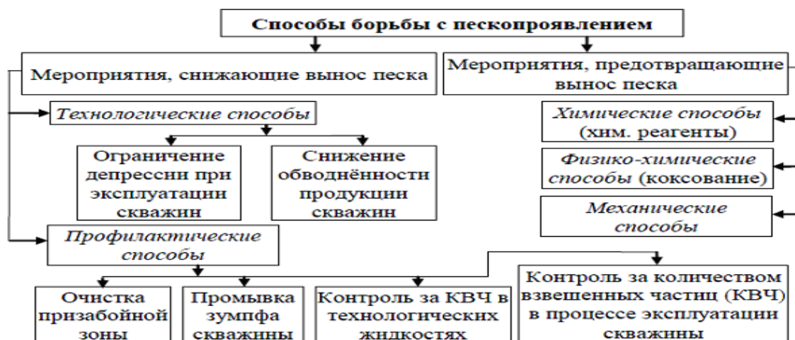
Рисунок 1 – Классификация современных способов борьбы с выносом песка из продуктивных пластов
