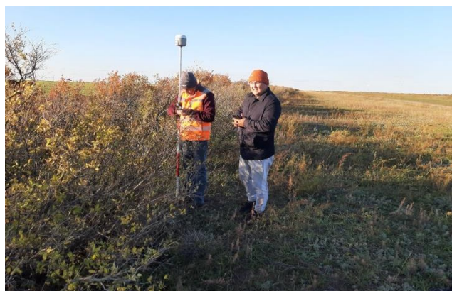
Рисунок 3 – Проведение геодезических и топографических изыскательных работ с помощью приемника Leica GS08plus+контроллер CS10
