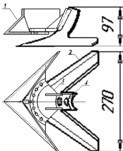
Рисунок 2. Крепление бороздооткрывателя к стойке лапы
